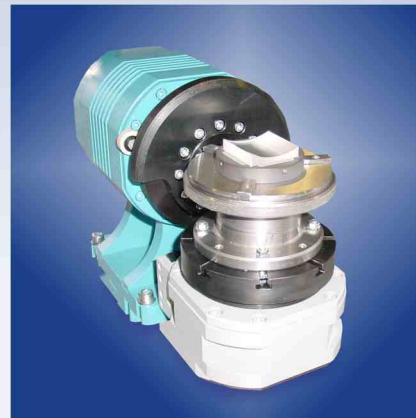
Прецизионные пятикоординатные станки DDM - 5D с прямым приводом на линейных двигателях предназначены для выполнения прецизионных шлифовальных и фрезерно-гравировальных работ по различным материалам.
